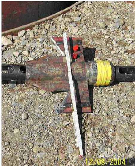
Abbildung 12 und 13 Schneidkopf und Baugrube für die Durchführung des PE-Berstens
