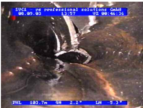
Abbildung 8 und 9 Einsturz einer gelochten und geschlitzten PE-Leitung
