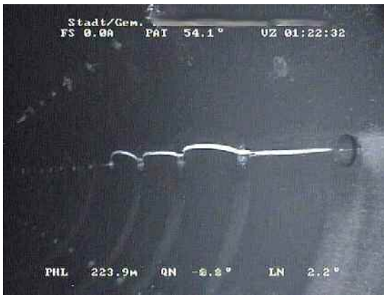
Abbildung 6 Sich von Loch zu Loch fortsetzender Riss
